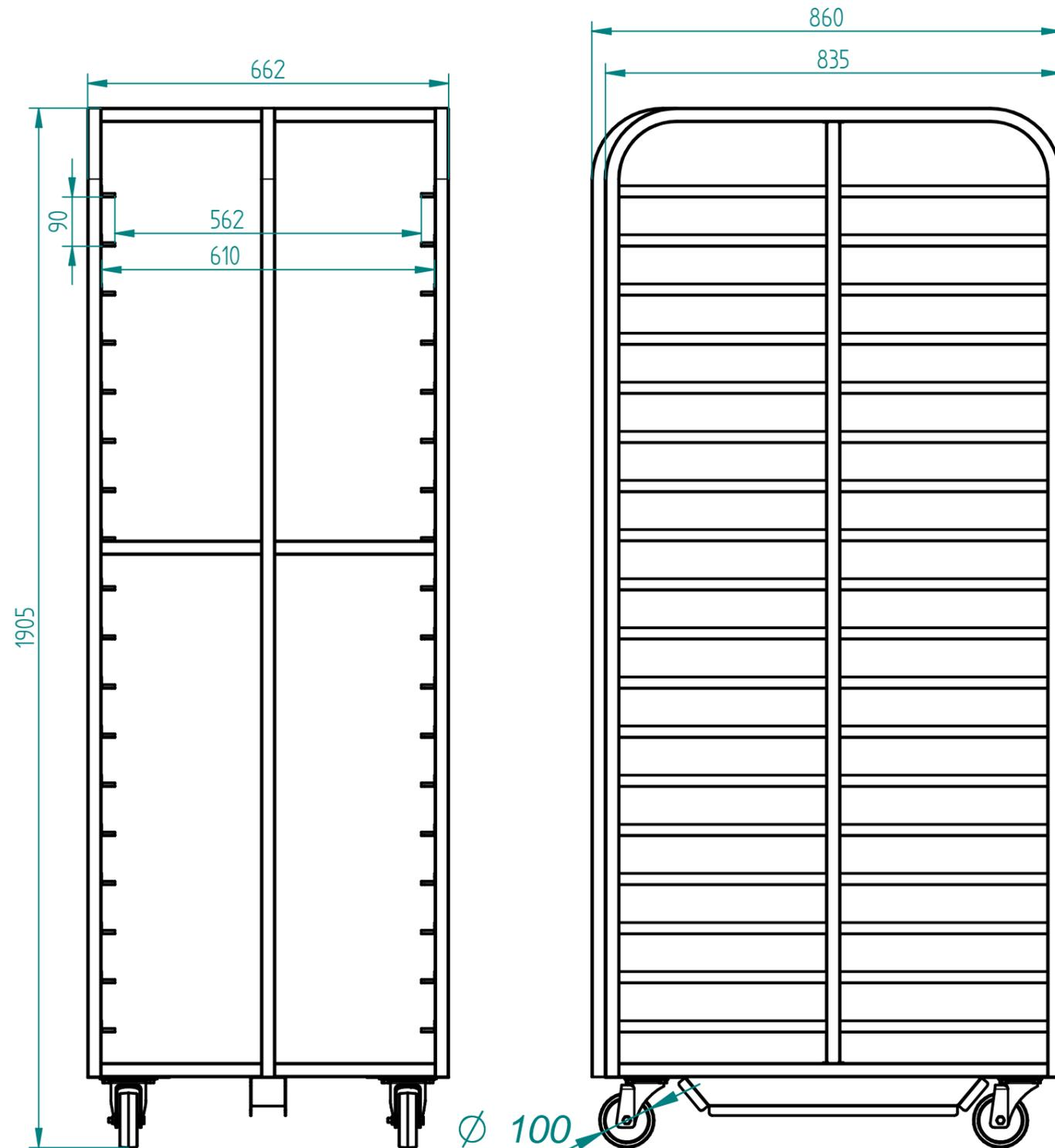
Тележка-шпилька ТШГ18 является вспомогательным оборудованием для предприятий общественного питания и для установки и транспортировки до 18-ти противней размером 600x800 мм. Имеет поворотные колеса. Допускается использовать в ротационном пекарском шкафу РПШ при приготовлении блюд, ввиду использования в тележке-шпильке термостойких колес.
